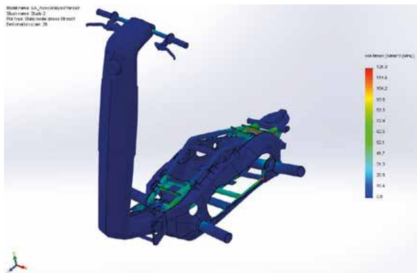
Figuur 4: Structurele analyse biedt spanningsverdeling om kritieke gebieden in kaart te brengen.
